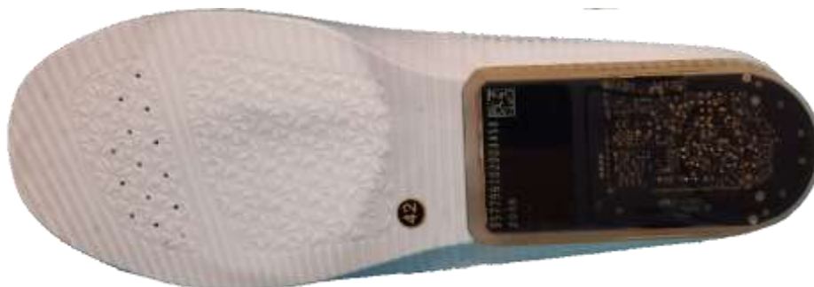
Semelle assemblée avec le module électronique
